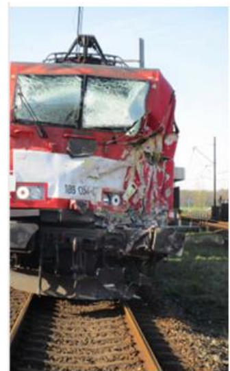
Figuur 18: Beeld van voorzijde locomotief locomotief 47612 na de aanrijding met aan.
